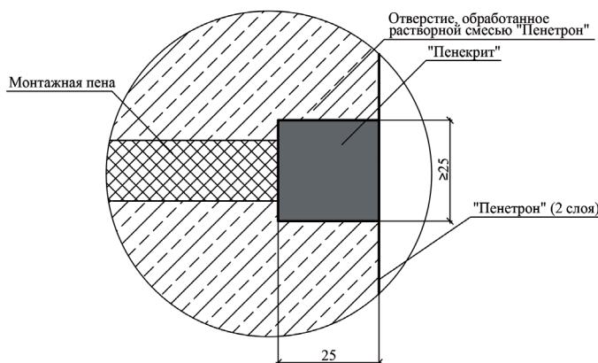
Существующая конструкцияГидроизоляция вводов инженерных коммуникаций
