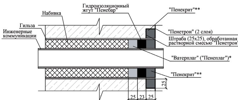
Существующая конструкцияГидроизоляция вводов инженерных коммуникаций
